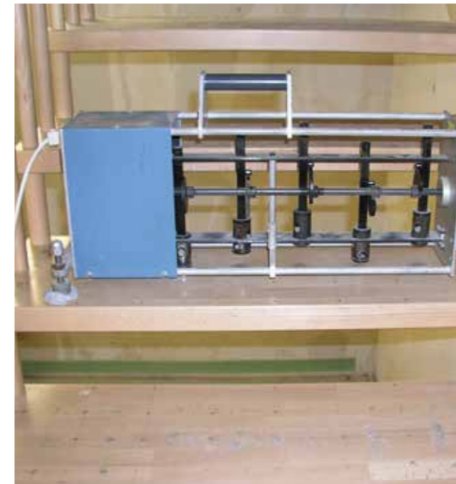
Treppenschallmessungen mit Normhammerwerk und Echtzeit-Analysator.
